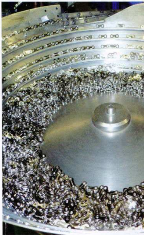
Oben: Die fertigen Laschen werden sortiert, in Position gebracht und von der Nietmaschine (rechts) zur Fahrradkette vernietet.
