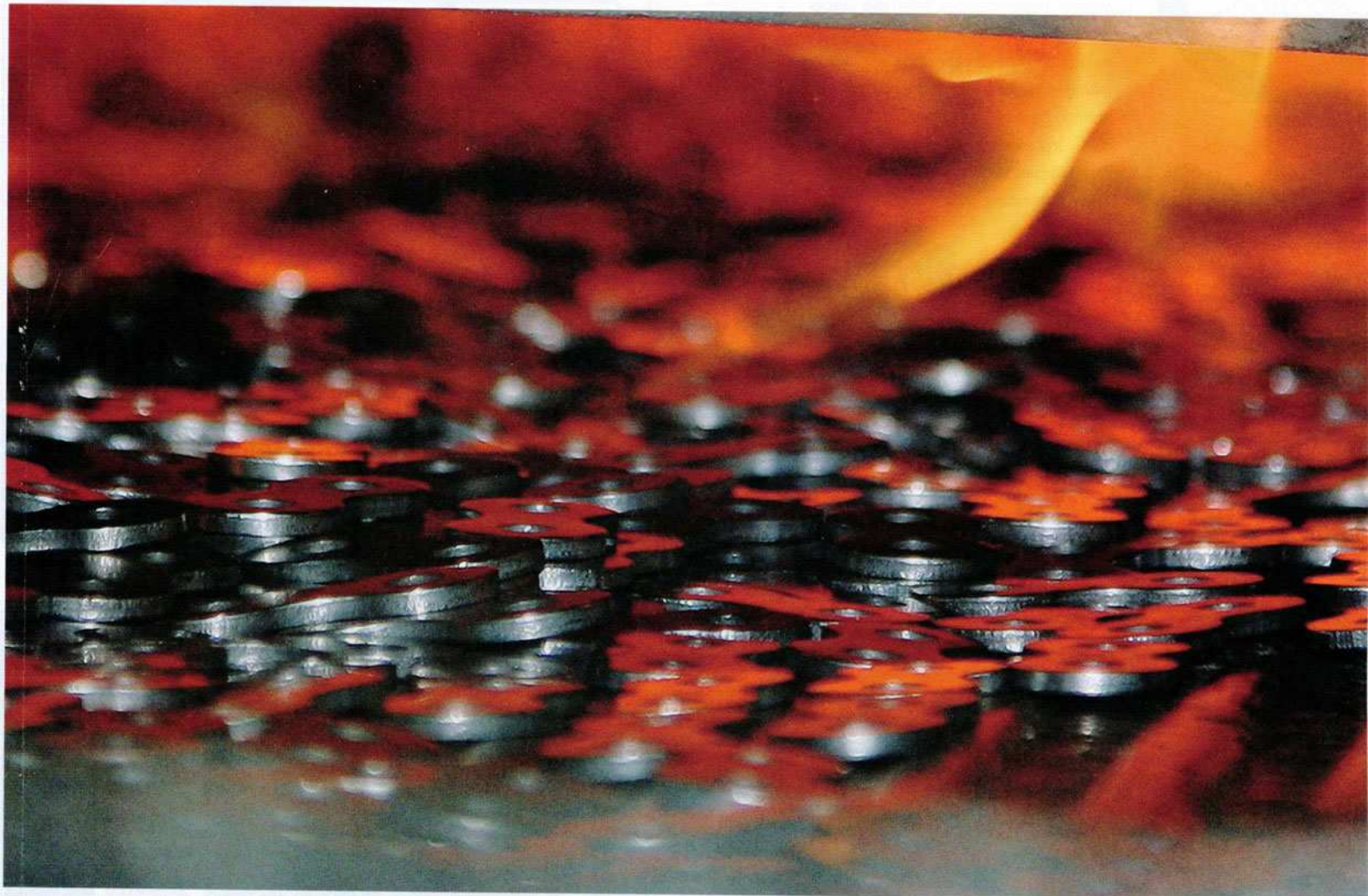
Hitzebehandlung: Die Laschen laufen auf Bändern durch einen Ofen, werden so ausgehärtet. Das soll die Bruchkraft erhöhen und vor Verschleiß und Korrosion schützen.
